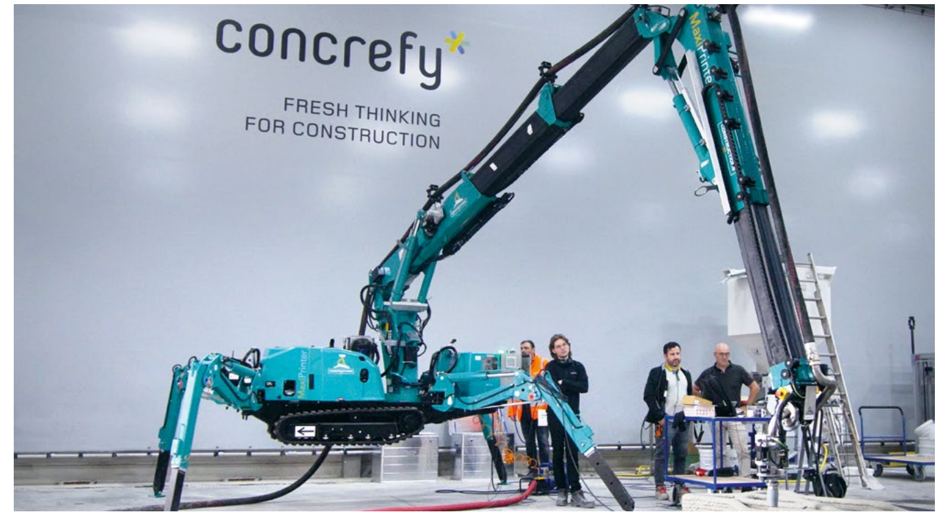
Der 3D-Baudrucker kann durch seine innovative Technologie und kompakte Bauweise nicht nur im Prefab, sondern auch direkt on-site auf der Baustelle eingesetzt werden.
